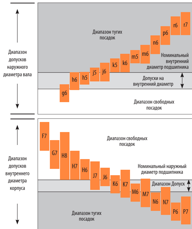
Рис. 5. Выбор посадки на вал и в корпус.
